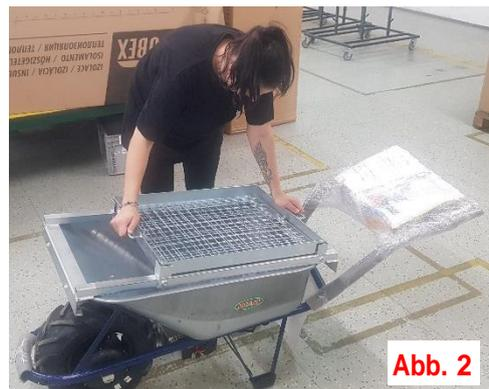
Zum Schluss genügt es, die Vibrationsunterlage mit den Spitzen in die Erde zu stecken, damit sie an ihrem Platz bleibt, das Vorderrad von Motokarre auf die Unterlage zu fahren, die Erde in das Sieb zu laden und mit der Vorwärtsfahrt zu beginnen. Dank der Vibrationsunterlage mit Rollen kann das Rad nicht wegfahren und beginnt aufgrund von Unebenheiten auf der Rolle zu springen/zu rütteln, wodurch die gewünschten Vibrationen entstehen und die Erde gesiebt wird.
