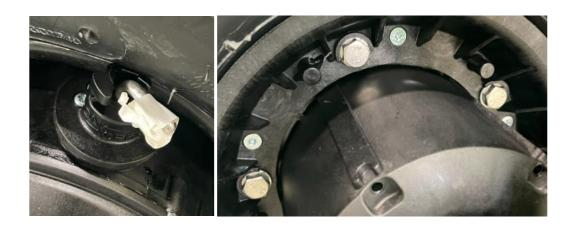
1/ Freilauf-Blockierung demontieren, 4x Schraube 4x14, Torx 20 Verlängerung. Dann einen neuen in umgekehrter Reihenfolge einbauen.
