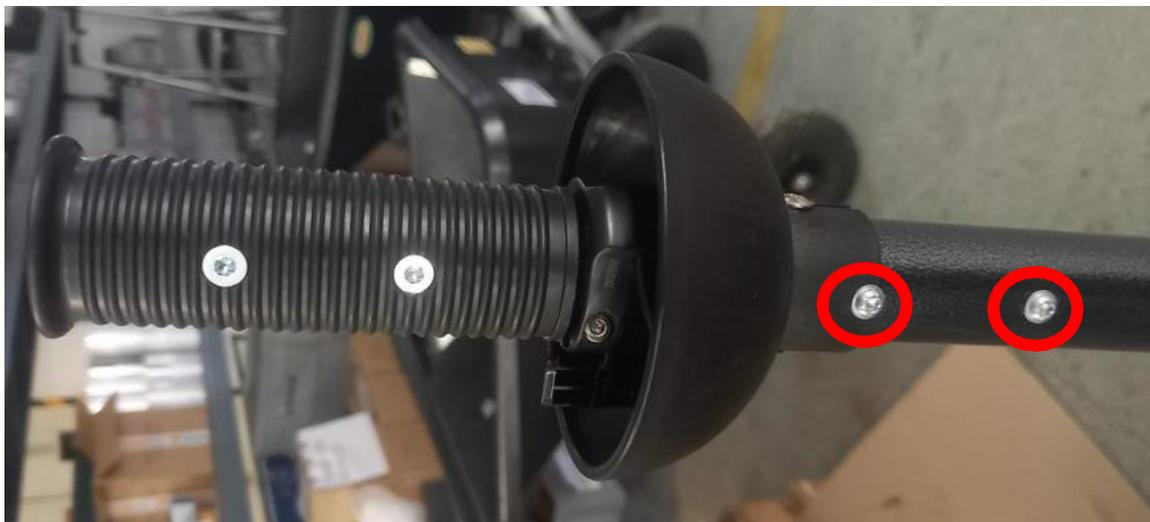
Für die Seitenschraube ist eine Modifikation des Rahmens erforderlich – bohren Sie die Steuerung mit einem 5,3-mm-Bohrer durch den Rahmen.
