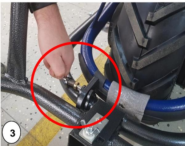
**Abb. 4-5** Die so abgesenkte Gabel unter die Last schieben oder die Last auf die Gabel legen. Durch Anheben von Motokarre in einer kippgleichen Bewegung in Höhe bis zum charakteristischen Klicken der Verriegelung das Schloss in der Transportposition sichern. Durch Drücken der Handgriffe nach unten wird die Last in die Transportposition angehoben.
